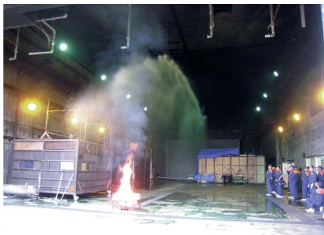
放水型スプリンクラーヘッドによる放水実験(能美防災メヌマ工場)
